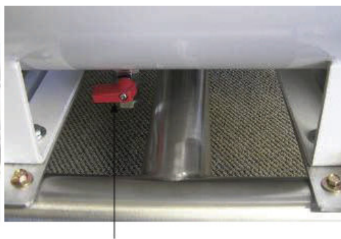
Kompressor-Ablassventil unter dem weißen Lufttank, langsam öffnen
